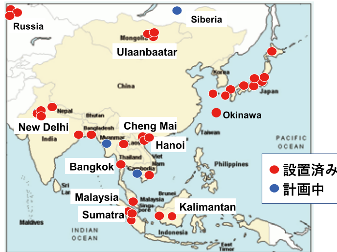
図6 著者らのこの2年余のアジア各地への小型PM 2.5 計の設置の状況。
