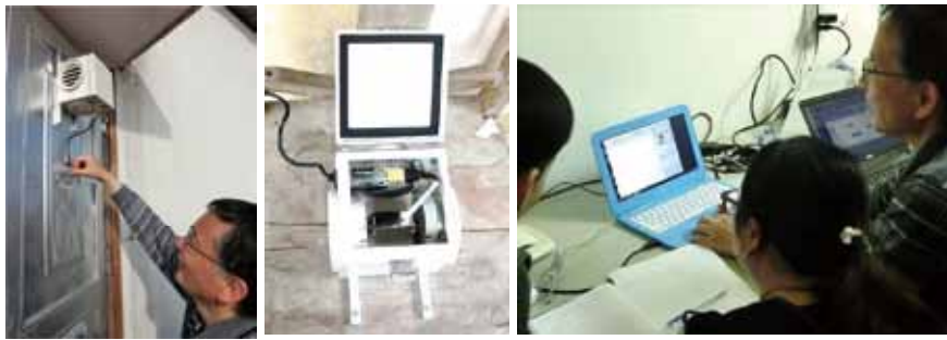
図5 ベトナムのハノイにて、据え置き型の小型PM 2.5 計の設置の様子。左と中：屋外のPM 2.5 センサとケース，右：センサからのUSBケーブルを室内に取り入れノートパソコンで記録・データ処理の様子。
