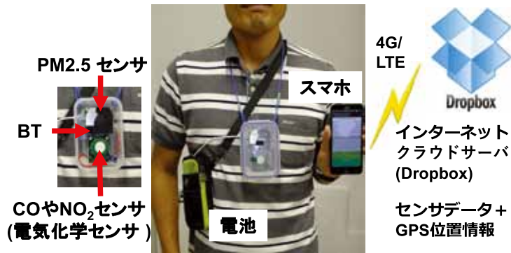
図9 著者らが製作している携帯型の小型PM 2.5 計の例。オプションとして、COやNO 2 のガス計測の電気化学センサも付加できる。センサの信号はBT(Bluetooth transmitter)でスマートフォン(スマホ, Android)に送られる。センサデータはGPS位置情報とともにリアルタイムでクラウドサーバーに送ることができる。また、スマホ上にグラフ表示される。
