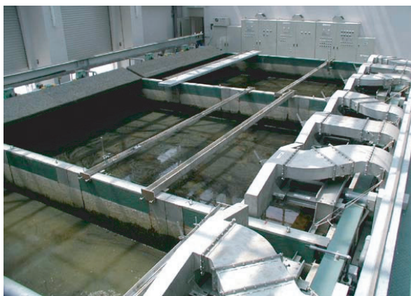
図9 干潟生態系モデルの再現性の検証に用いた愛知県水産試験場の干潟メソコスム。(室内干潟環境再現施設)
