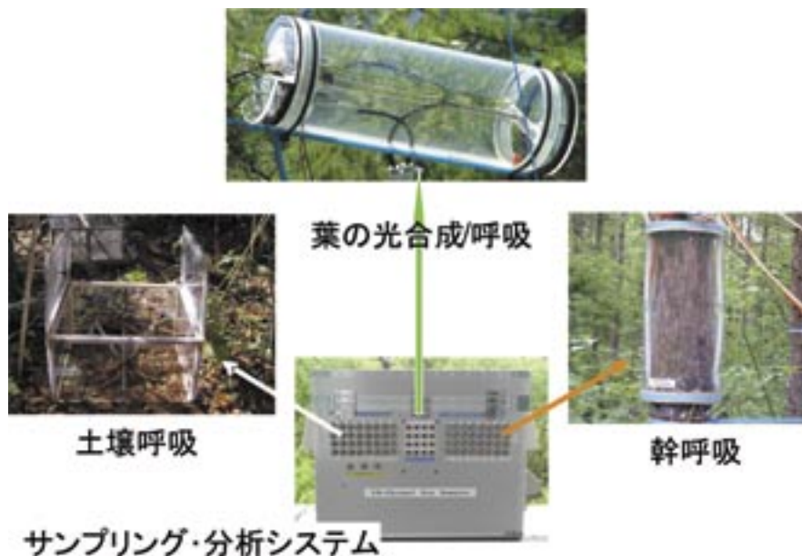
図1 土壌・光合成・幹呼吸を測定するチャンバーシステム。 共通のサンプリング分析システムで蓋の開閉や観測を無人で行うことができ、長期の自動観測が可能である。また、電力消費を30 W程度に抑制してあるので、太陽電池で稼動する。(土壌呼吸に関してはLiang et al. 1) )
