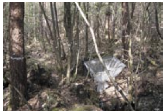
図4 山梨県富士吉田市のタワーフラックス観測サイトであるアカマツ二次林内に設置されたリタートラップ。受け口の面積は 1 \text{ m}^2 であり、筒状のネットの底部を地面に触れないように紐で縛ってある。周辺の樹木には直径の測定位置をペンキでマーキングしてある。
