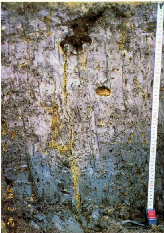
図8 パイライトを含む海成粘土層（タイ・ナラチワ県）
