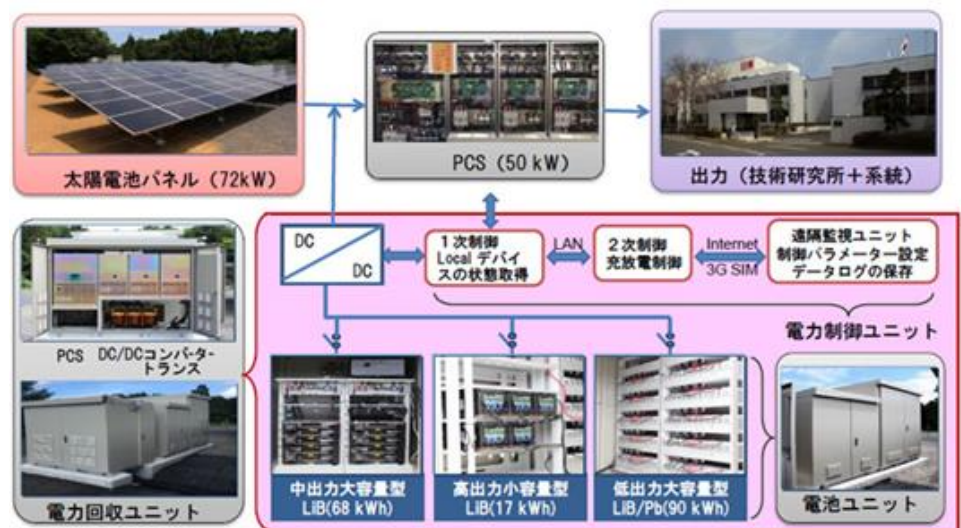
図 2: 太陽光発電の電力回収システム構成
