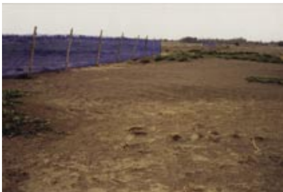
図7 高さ2mの2種類の防風ネット設定と砂堆の状況。
